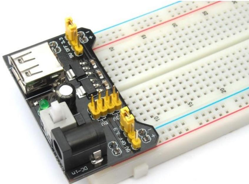
Dies ist ein Power Supply Modul für MB102 Breadboard und Prototype Board.
